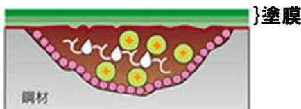
放出された腐食抑制剤が鋼材素地を不働態化する
