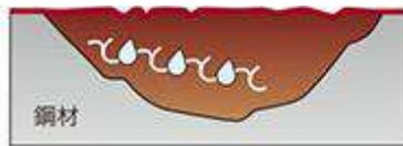
湿気硬化形樹脂が水分を取り込んで固め、さびを強化
