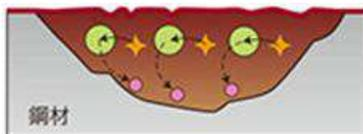
イオン固定化剤の中に腐食性イオン(塩分)を取り込むことによって、さび発生の促進要因となる腐食性イオン(塩分)を無害化する
