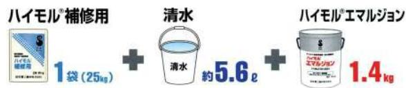
モルタルミキサー、ハンドミキサーにてよく混練してください。(可使用時間は約1時間です)
